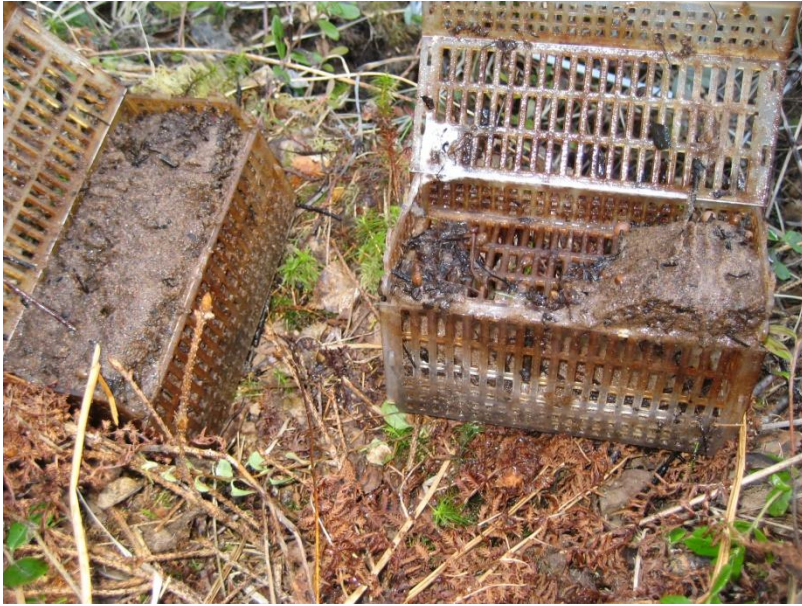
Hallahuhdanojan rasiat olivat täyttyneet hiekkapitoisesta kiintoaineksesta.
